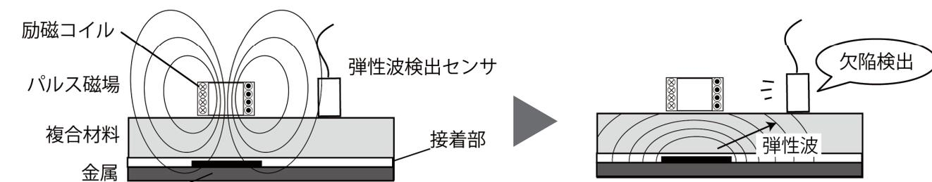
欠陥 (剥離、弱接着など) 励磁コイルが作るパルス磁場が金属の表面を励振します。これにより発生した音響(弾性波)をFRP表面側で計測・分析することで、接着部の欠陥を発見します。
