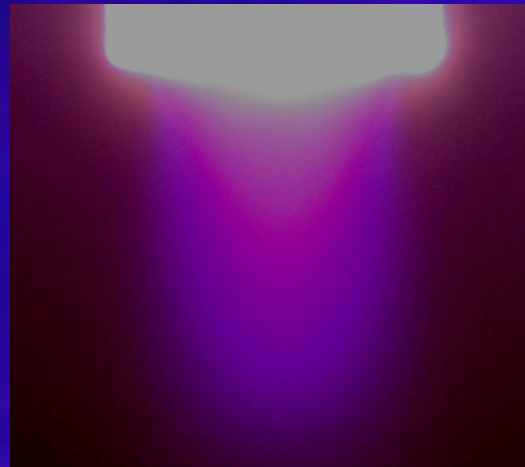
大気圧低温プラズマ流の可視化
