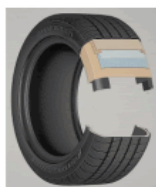
サイド補強型 ランフラットタイヤの構造
