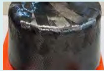
② CFRP積層
