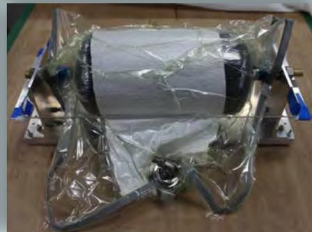
CFRPでクレストをサンドイッチし真空加圧成形
