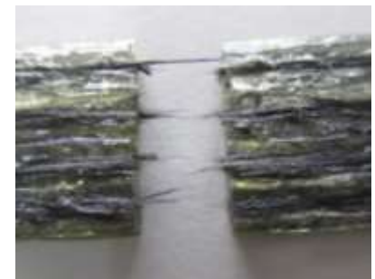
3D Printされた複合材試験片の破断面
