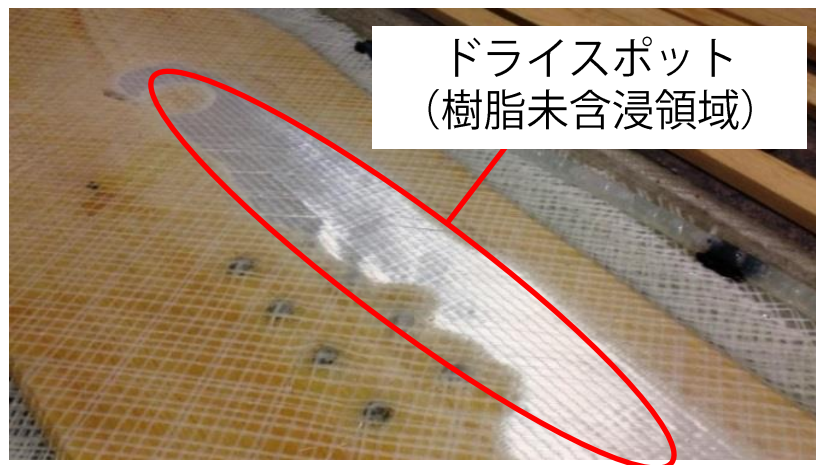
VaRTMによるGFRP成形品
