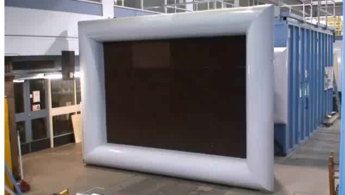
Durham大学の乱流変動発生装置
