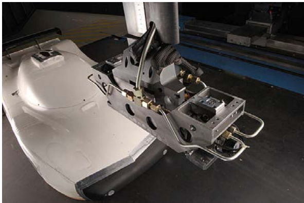
RUAGの加振装置(ピッチ・ヒービング等)
