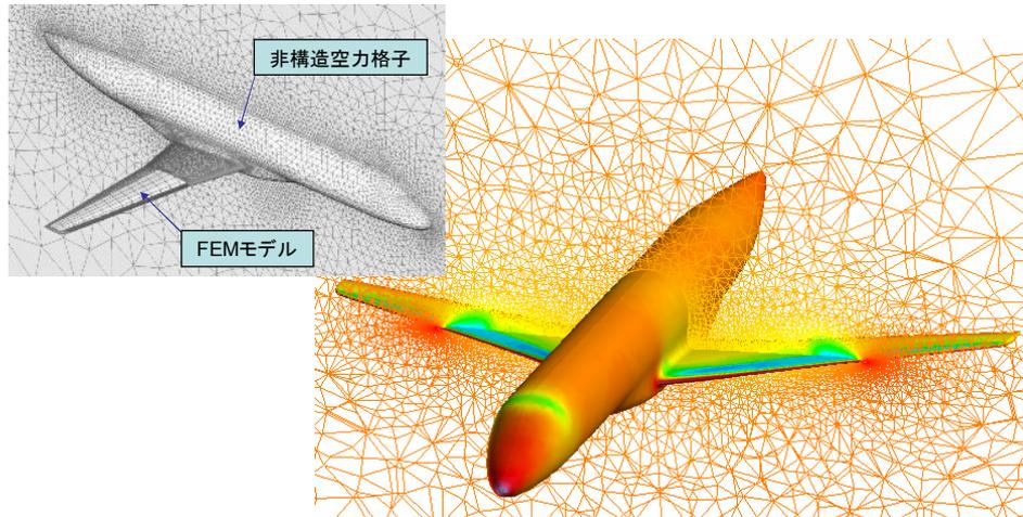
CFD&FEMによる高次解析モデルと、遺伝的アルゴリズムを用いた最適化ツールを組み合わせることで実設計を見据えた翼設計システムを構築
