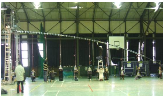
図 4 荷重試験(1.5G)
