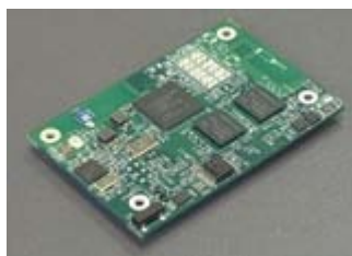
図 4 Linux ボードコンピュータ CM-X300 (66 x 44 x 7 mm)
