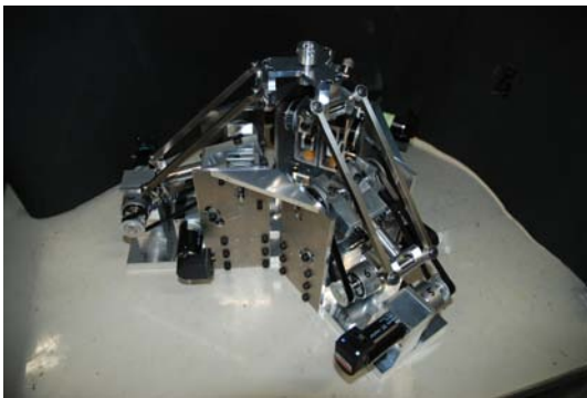
図：可変剛性を有する改良型デルタ機構
