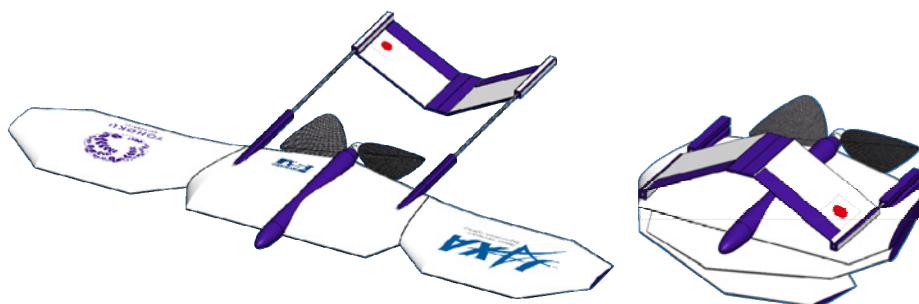
図 4 翼展開機構をもつ火星飛行機の概念設計の一例
