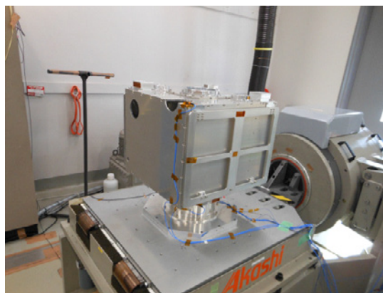
左：RISESATイメージ，右：RISESAT振動試験（MTM）
