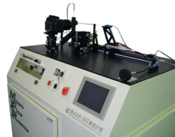
(6) 温度分布制御マイクロフローリアクタによる低温酸化反応分離（n-ヘプタン）および実用化された着火燃焼特性測定装置
