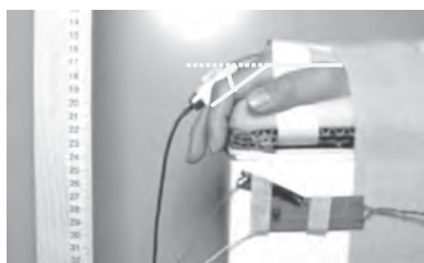
図1. 連続パルスによる指先上昇距離の測定 図2. 磁気パルス数に対する指先の上昇距離
