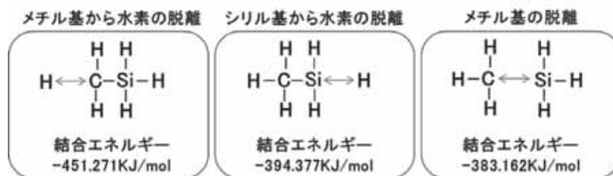
図1：第一原理計算を用いたメチルシランの結合エネルギー
