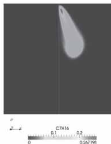
図 5：高圧条件下における噴霧微粒化液滴群の濃度分布
