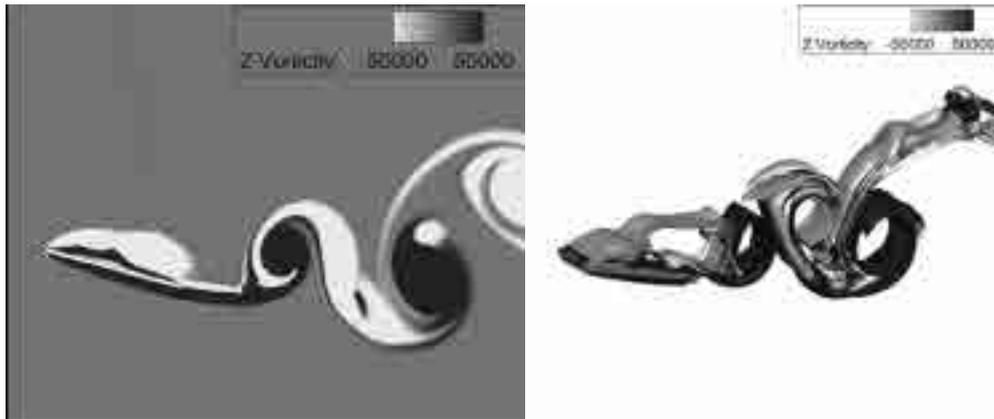
図 2 : 2 次元と 3 次元の迎え角 15°の固定翼周りの可視化結果
