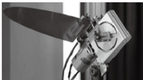
図1: 羽ばたき翼模型
