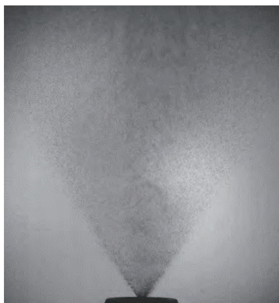
図2 大気圧下における液体アンモニア噴霧のバックライト画像 Fig.2 A back lit image of liquid ammonia spray at atmospheric pressure
