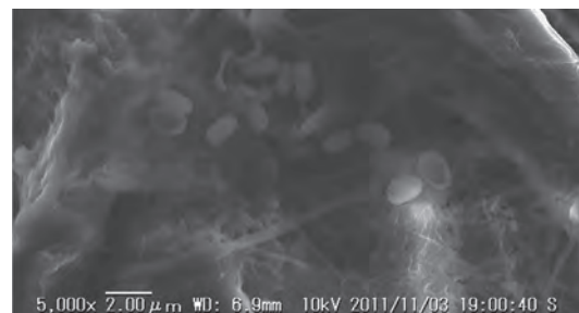
プラズマ照射による芽胞菌の滅菌、芽胞菌に孔が形成された様子 Sterilization of bacterial spores by plasma irradiation, formation of pores in the bacterial spores
