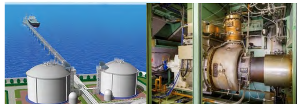
大型アンモニア受入基地 IHIプレスリリース (2021.10.5) より 2MW-class gas turbine
