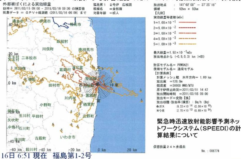
図9 SPEEDIによる放射線推定(2号機SC破壊による放射線放出を仮定)(Rep.15.3)
