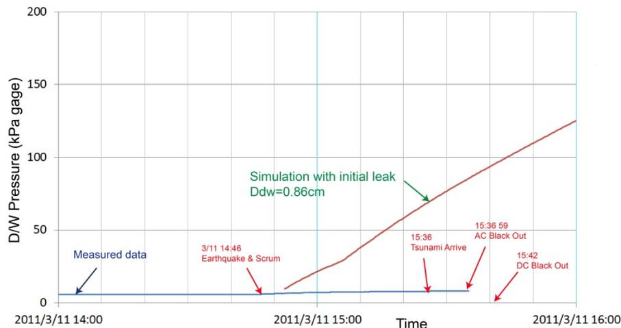
図 1 津波到達前の D/W 圧力実測値（原子力規制委員会、2014.7.28）と前報までに仮定した(HTC Rep.32.2, 2014/03/05)および（円山、機論 2014.12）初期漏洩による D/W 圧力変化の比較
