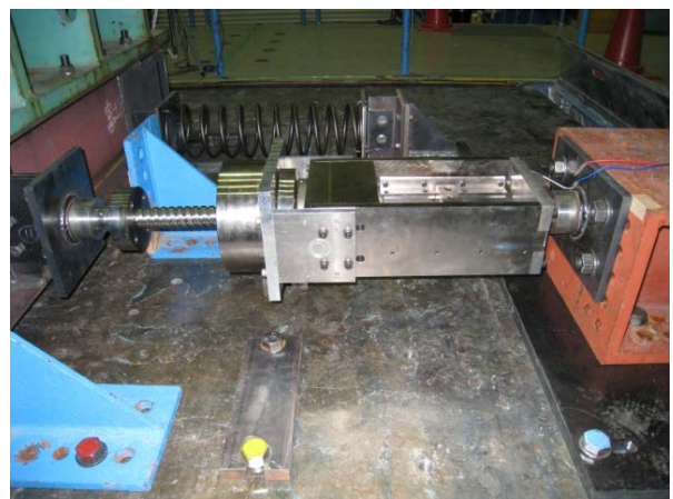
振動台免震試験時の開発されたMRダンパの設置
