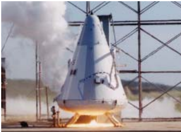
再使用型ロケット実験機の地上燃焼試験
