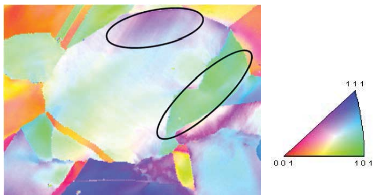
図 2 エッチング後表面の EBSD 解析結果
