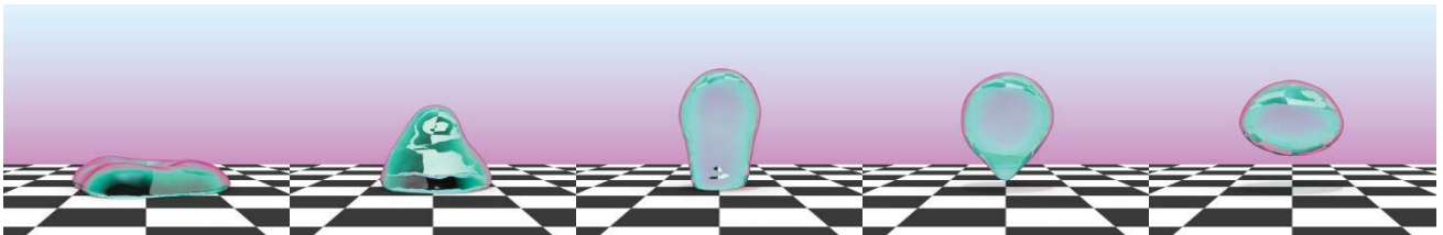
図 2. 壁面へ衝突し潰れた水滴が空気中へ跳ね返る様子。粒子分布をもとに密度等高面を抽出し水滴表面形状として可視化した。
