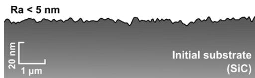
図3 初期しゅう動面の断面曲線
