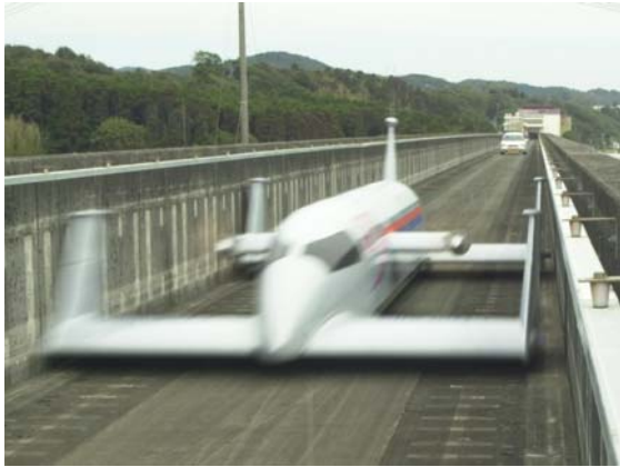
A. 環境親和型高速輸送システム“エアロトレイン”（左：走行実験風景，右：数値計算結果） Ground Effect Transportation System, “Aero-Train” (left: experiment, right: CFD result)
