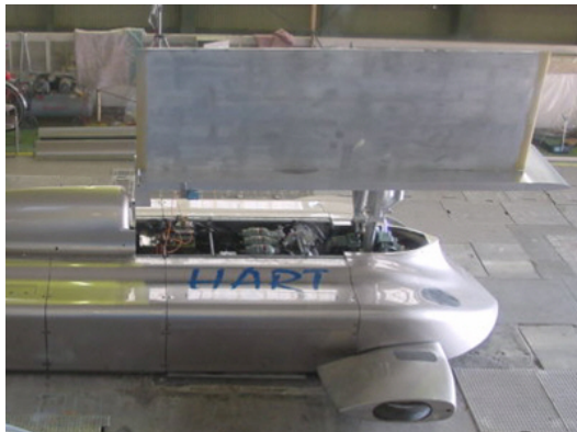
B. 流動環境シミュレータ実験設備による平板境界層遷移レイノルズ数測定 Measurement of transition Reynolds number by “HART: Hyuga Aerodynamic Research by Towing”
