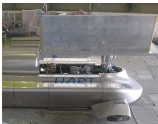
Fig. B 流動環境シミュレータ実験設備 Towing wind tunnel, “HART”
