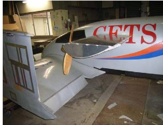
Fig. B 安定性向上のための制御翼モデル
