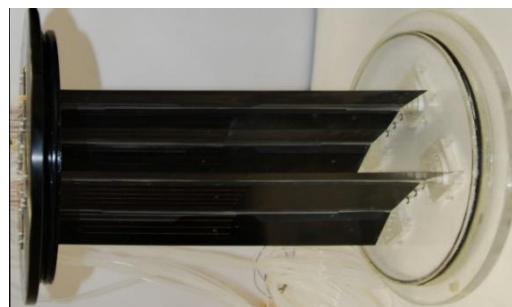
図 2 超音速複葉翼フラップ模型
