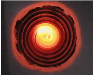
図1 熱源用マイクロコンバスタの内部可視化
