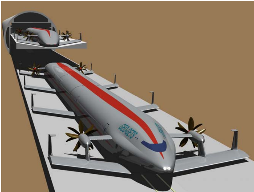
図1.エアロトレインを利用した成田空港ー羽田空港間の大深度地下走行型の高速度輸送システムの想像図。 360人乗り、400 km/h、東京経由で12分で接続可能。
