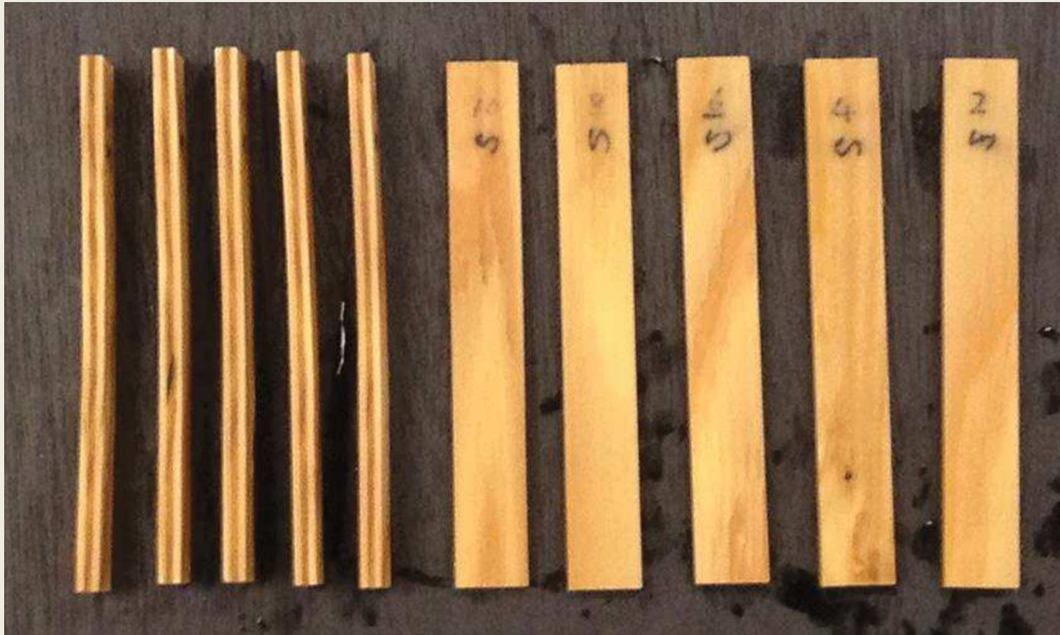
4時間煮沸後の1.0mm・3ply試験片
