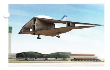
CFDによる数値シミュレーションと風洞実験を融合させ、超音速複葉機の設計に応用しています。JAXA (宇宙航空研究開発機構)との間で包括的研究協定も締結され、シラキュース大学との間でも国際共同研究が進められています。
