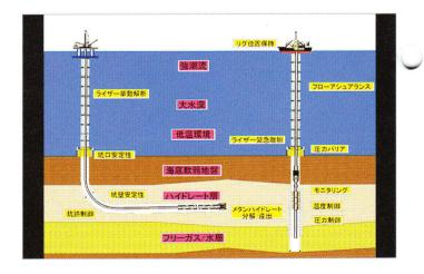
地層力学と流動力学を融合。地層内に人工バリアーを製作することで、CO2の地層内貯留を実現することを目的としています。この技術は核廃棄物の地層処分にも応用が可能です。また、石油天然ガス開発のモニタリングシステムの開発も視野に入れています。
