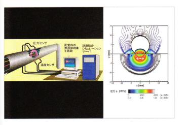
計測とシミュレーションを融合させることによって、原子炉内配管の減肉を評価・予測 し、原子炉の安全性を向上させることが研究の目的です。材料工学と流動工学を融 合し、原子炉内に設置する先進的センサーの開発に取り組んでいます。
