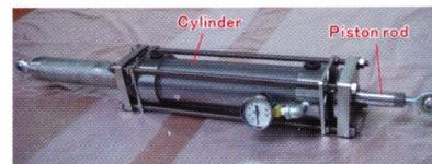
開発した変位と速度に応じて減衰特性の変化する免震・制振用ハップ式MR流体ダンパ
