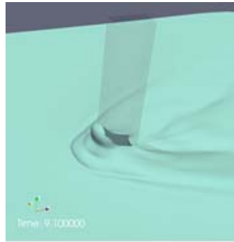
橋脚に衝突する洪水流の流体力予測に関するスーパーコンピューティング Supercomputing of hydrodynamic behavior of supercritical floodwater impingement to bridge girder
