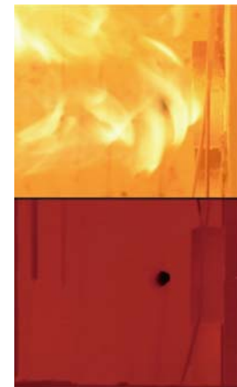
高温空気燃焼条件（上）と高温酸素燃焼条件（下）の火炎画像 Flame images in HiCOT condition (upper) and HiTOx condition (lower)
