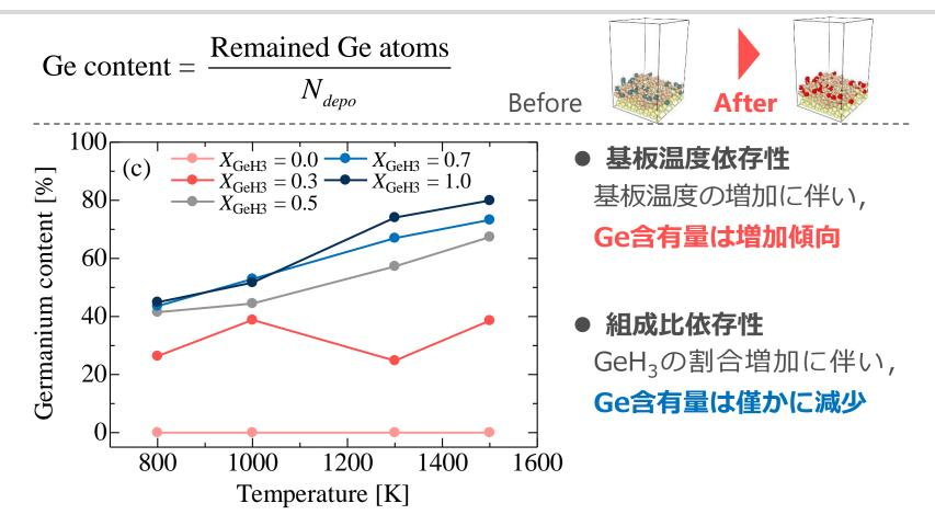
基板温度増加に伴い成長表面から水素分子(H<sub>2</sub>)が 脱離し,相対的にGe含有量は増加したと考えられる Si含有量は $X_{GeH3}$ の増加に伴い急激に減少し, $Ge含有量は急激に増加する傾向が確認された <math>\Rightarrow Geは優先的に薄膜内に取り込まれる$
