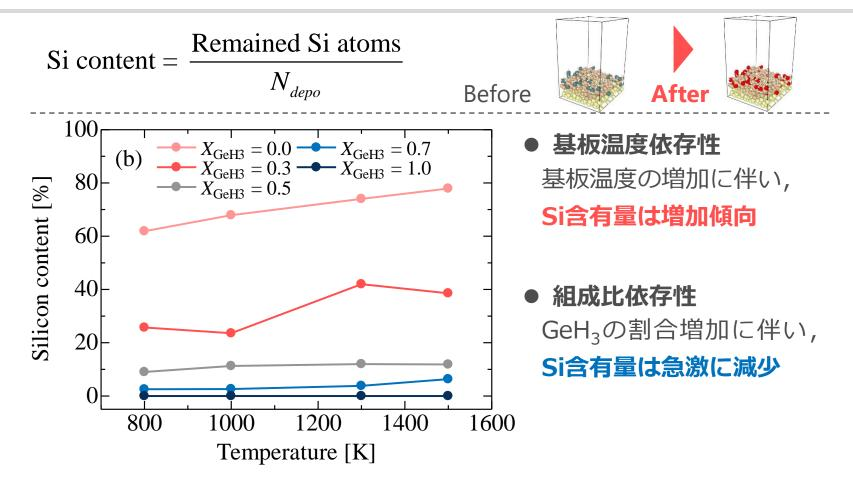
基板温度増加に伴い成長表面から水素分子(H<sub>2</sub>)が 脱離し、相対的にSi含有量は増加したと考えられる。
