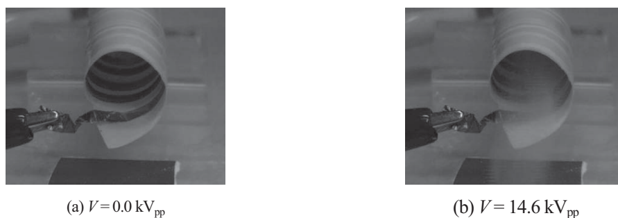
図 3 DBD プラズマチューブによるアルミナ粒子搬送の様子
