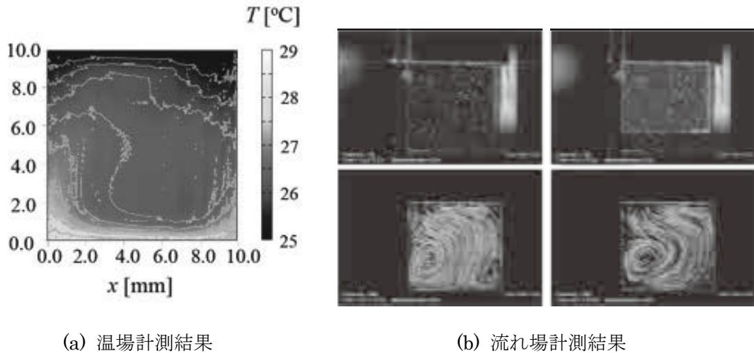
図2：同時計測システムによる温度場及び流れ場の可視化結果
