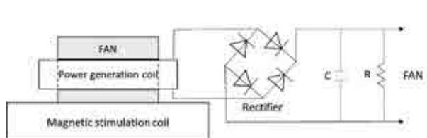
図1：冷却ファン駆動原理図
