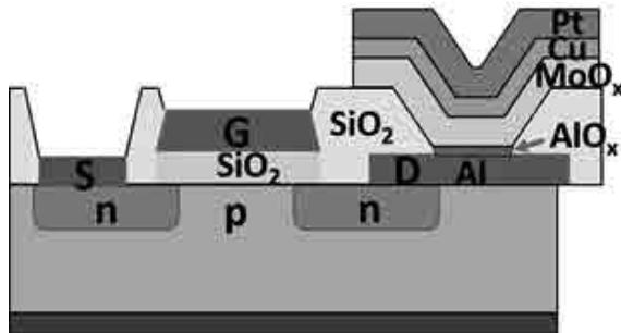
図 1 : MOSFET を接続した MoO<sub>x</sub>/Cu 系 ReRAM 素子の模式的断面構造図
