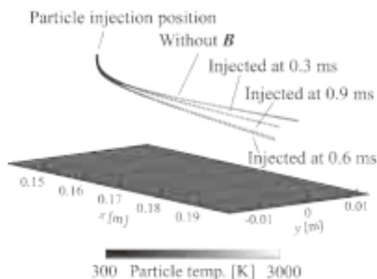
図2：溶射粒子の飛行軌道に沿った温度履歴
