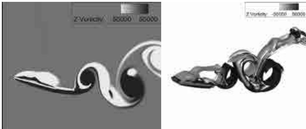
図 2 : 2 次元と 3 次元の迎え角  $15^\circ$  の固定翼周りの可視化結果
