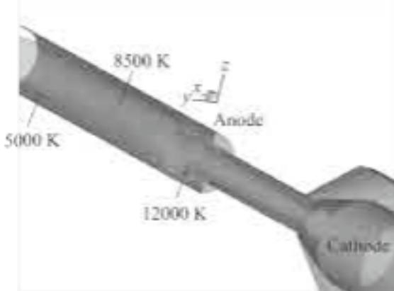
図1：外部磁界印加型 ( $B=0.8\text{ T}$ ) 大気圧溶射装置内における温度分布)
