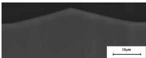
図1：63-75μm の粉末により成形した成形体の長手方向断面のSEM像
