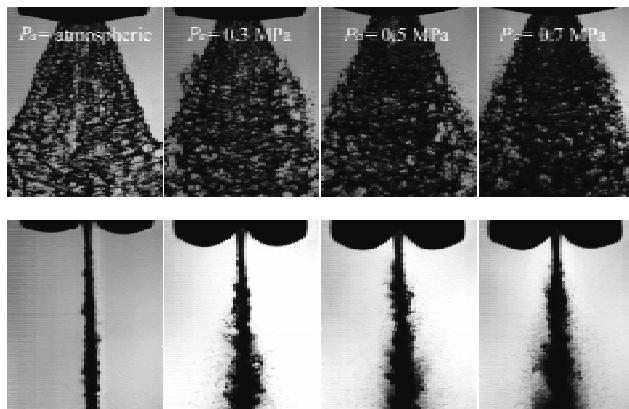
図1：常温水のスプレイノズル噴射可視化写真。噴射差圧 1.3 MPa で固定。
