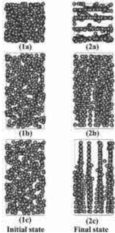
図1 強磁性微粒子の分布状態。分布図はそれぞれ(1)初期状態および(2)定常状態。(a)上壁面方向、(b)流れに対して横方向から、(c)流れ方向からそれぞれ見た図。 $Re=0.4$ ,  $B=25$  mT.
