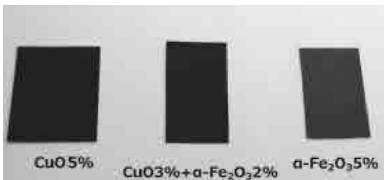
図1 作成したふく射制御塗料の写真
