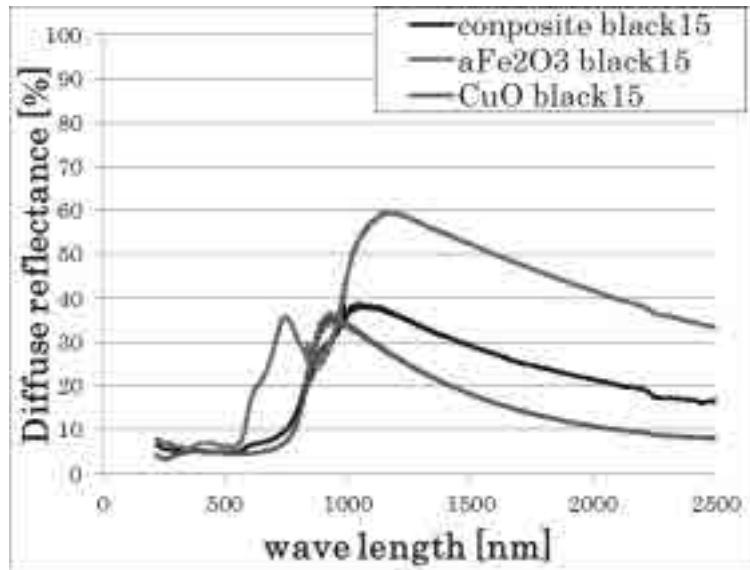
図2 作成したふく射制御塗料の分光反射率
