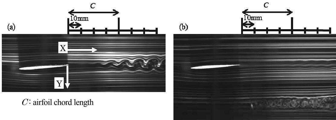
図 1 : smoke-wire による可視化. (a)細い針金なし, (b) 細い針金を(10,30)に挿入
