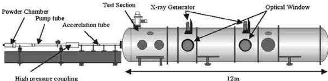
図 1：二段式軽ガス銃（東北大学 流体科学研究所）
