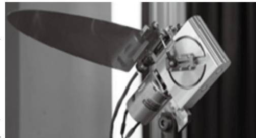
図1：羽ばたき翼模型
