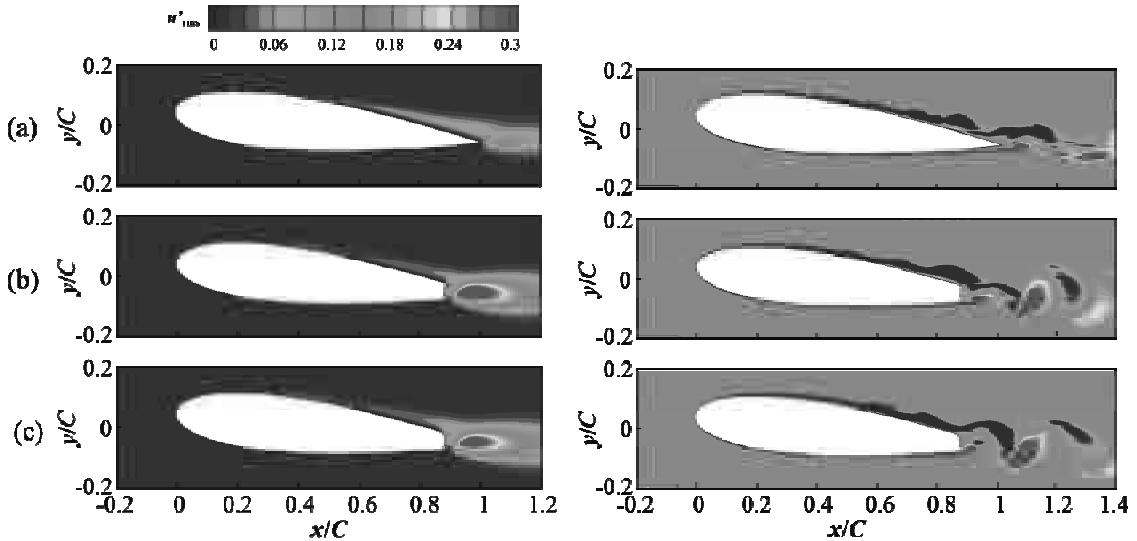
図1：翼周りの鉛直方向速度変動分布（左）と Powell 音源分布（右），(a) 通常翼, (b) 対称フラットバック翼, (c) 非対称フラットバック翼
