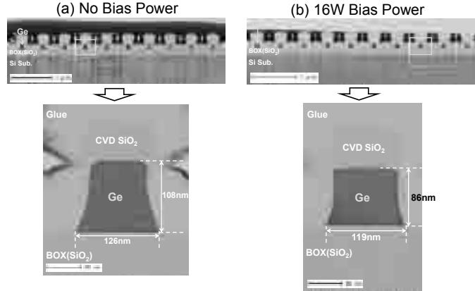
図 2 (a) 中性粒子ビームを用いて加工したマルチ Ge Fin チャネルの断面 TEM 像. (a) バイアスパワーなし, (b) バイアスパワー16W.
