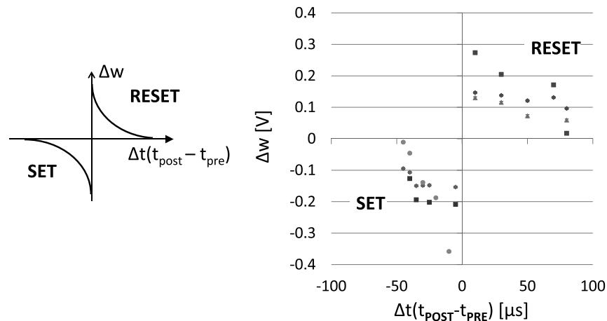
図 5：生体での典型的な STDP 特性(左)と、試作した ReRAM 素子での実現した STDP 特性(右)
