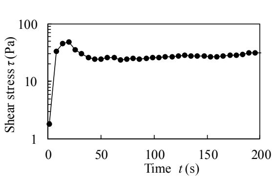
図1：せん断応力の時間応答 ( $\dot{\gamma} = 1.0 \text{ s}^{-1}$ )
