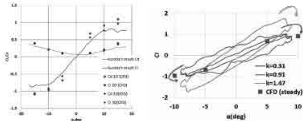
図 1：固定した平板翼周りの空力係数の比較（左）と
