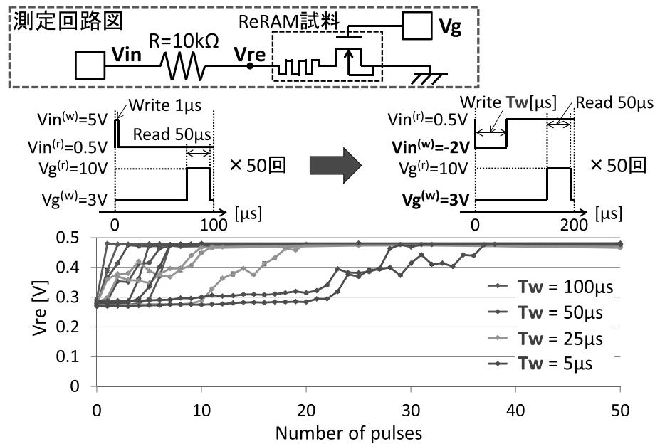
図 4：パルス印加 RESET 動作における抵抗値のアナログ的変化特性
