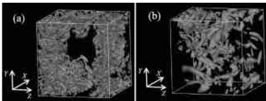
図1：単一四角格子により生成された非平衡乱流中のコヒーレント渦構造。(a) 格子近傍, (b) 下流域。単一四角格子背後のコヒーレント渦構造( $Q$  値により可視化)の空間分布が位置によって大きく異なることがわかる。
