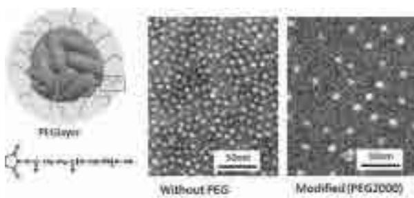
図2. ポリエチレングリコール修飾層を持つたフェリチンの模式図と分子量2,000PEG修飾によるフェリチン分子間距離の制御結果を示すSEM像.
