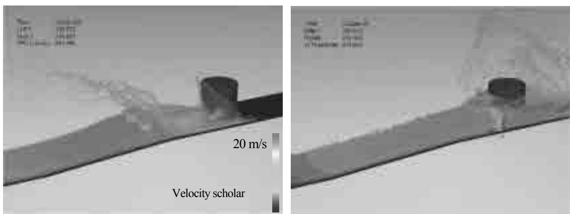
図 2 津波による小型タンク漂流と陸上構造物への衝突現象に関する融合数値計算結果
