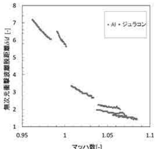
図 2：飛行マッハ数 vs 衝撃波離脱距離
