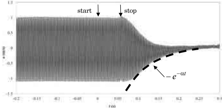
図2. 薄板の迎角を0度から18度に急変。矢印は、迎角変化の開始と停止を示す。
