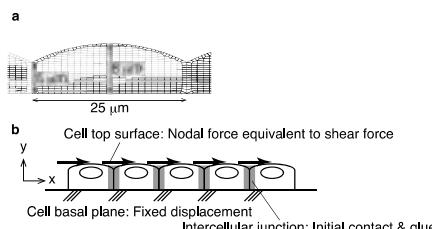
図1：(a) 血管内皮細胞の2次元有限要素モデル (b) 非線形接触解析のための境界条件
