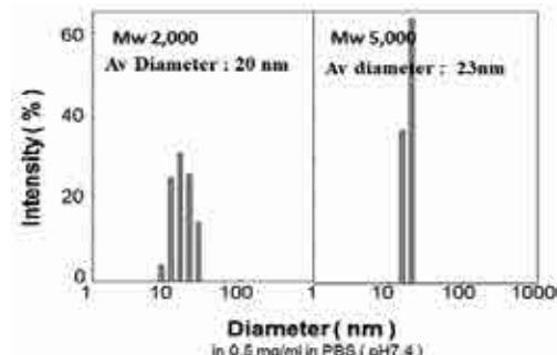
図1. 分子量2,000, 5,000のポリエチレングリコール修飾層を持つフェリチンのDLM測定結果
