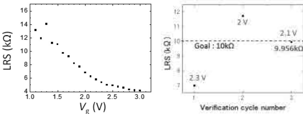
図 3 : 作製した MOSFET 付き ReRAM のゲート電圧-抵抗値の関係 (左) とアノログ抵抗値制御 (右)
