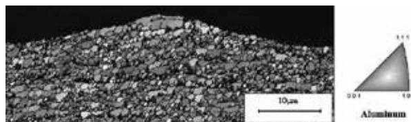
図2：63-75μm の粉末により成形した成形体のIPFマップ
