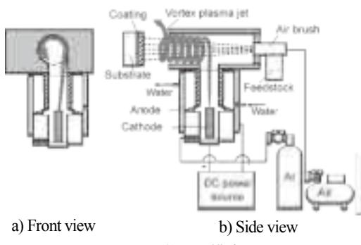
図1：ASPPS装置の模式図
