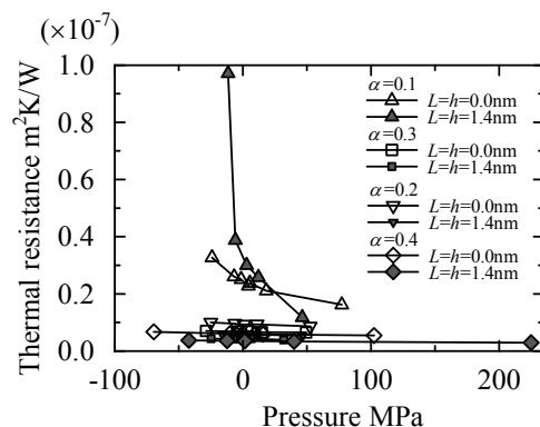
図 1: フラット界面およびナノ構造化界面における系内圧力と固液界面熱抵抗の関係
