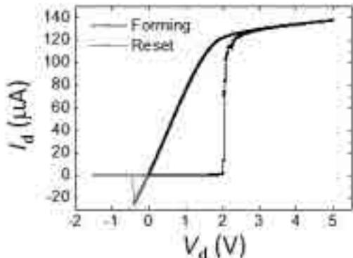
図 2 : 作製した MOSFET 付き ReRAM の I-V ヒステリシス特性
