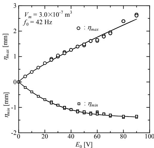
図 1：磁性流体界面振動における最大変位および最小変位の印加電圧依存性
