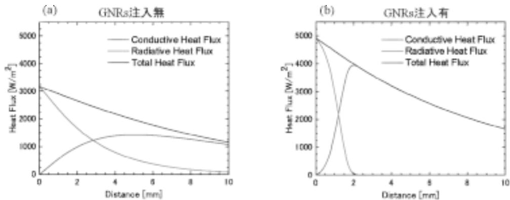
図2: GNRの有無による伝導熱流束, ふく射熱流束, 全熱流束の比較
