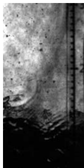
図2 流動様式サンプル画像（カメラ仕様：FASTCAM NOVA、Max. 解像度 1024X1024、撮影速度 6400 コマ/秒） （水平管サイズ 40A、飽和蒸気流量 357 kg/h、蒸気圧力 0.68 MPa、乾き度 0.906）
