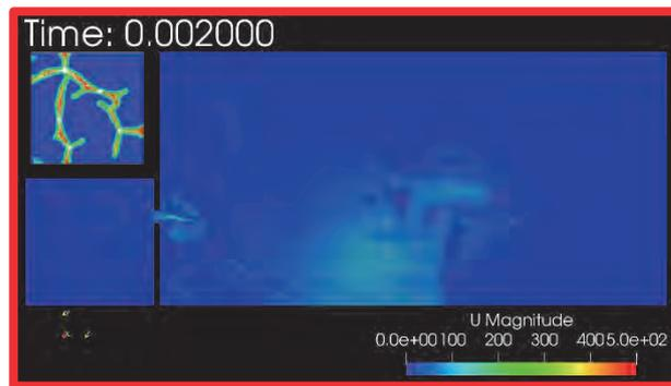
図1 漏えい水素のき裂伝ばと流速分布 に関する時間発展計算結果
