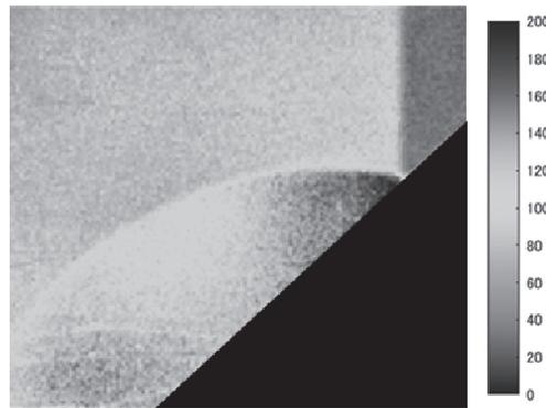
図 1：衝撃波の反射現象の可視化（入射角 30°， $M_s = 1.5$ ）
