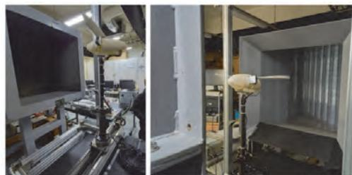
図 2: 空気力測定
