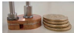
コインサイズコンバスタ (直径：20 mm) Coin size combustor (Diameter: 20 mm)
