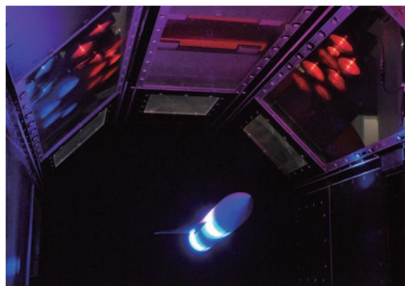
6軸制御による浮揚するAGARD-B模型 AGARD-B model suspended by 6-axis control of MSBS
