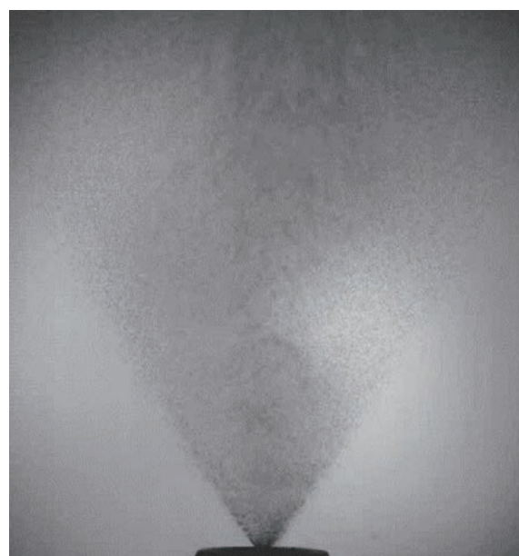
図2 大気圧下における液体アンモニア噴霧のバックライト画像 Fig.2 A back lit image of liquid ammonia spray at atmospheric pressure
