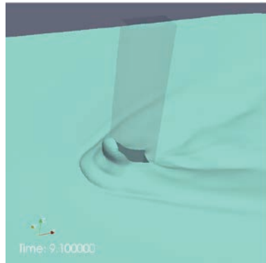
橋脚に衝突する洪水流の流体力予測に関するスーパーコンピューティング Supercomputing of hydrodynamic behavior of supercritical floodwater impingement to bridge girder
