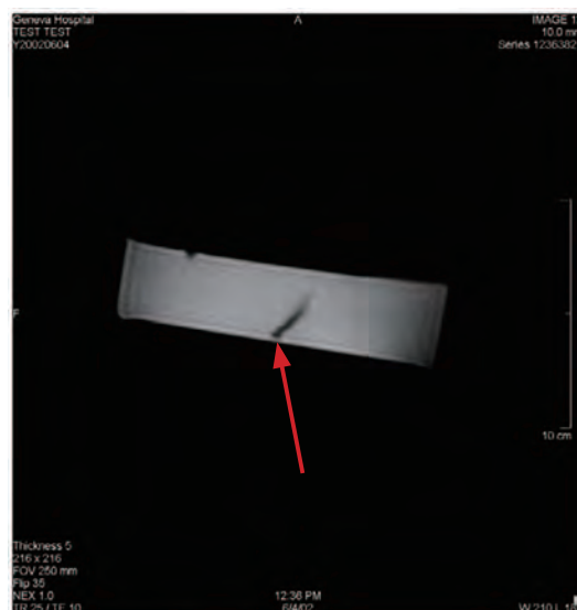
クライオセラピーで用いるニードルを PVA 固形に穿通した様子を MRI で撮影した
