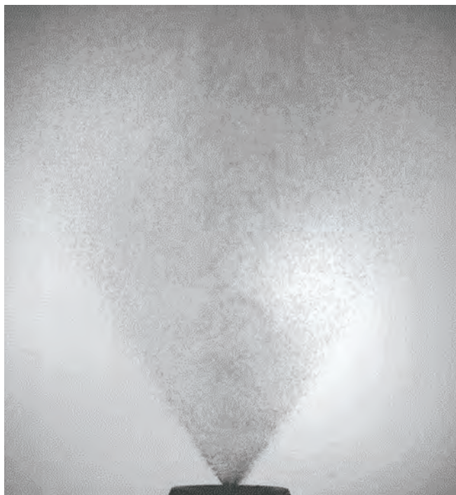
図2 大気圧下における液体アンモニア噴霧のバックライト画像
