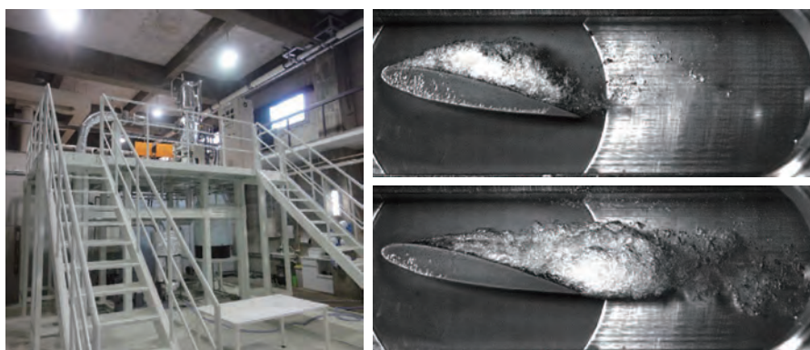
高温水キャビテーションタンネル実験設備と NACA0015 翼形まわりのキャビテーションの様相 (140°C) Hot water cavitation tunnel facility and the aspects of cavitation around NACA0015 hydrofoil (140°C)
