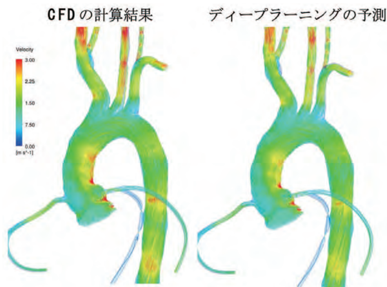
大動脈流れの流線を可視化 (左:CFD により得られる数値解析結果、右:ディープラーニングによる予測結果)
